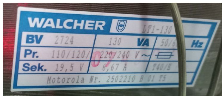
Etiquette collée sur le Transformateur
